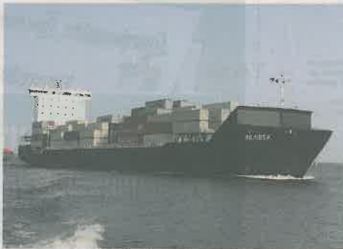
Die RHL Reinbek ist 169 Meter lang und bringt es auf eine Geschwindigkeit von 20 Knoten. Sie hat eine Container-Kapazität von 1600 TEU und fährt unter der Flagge Liberias.
